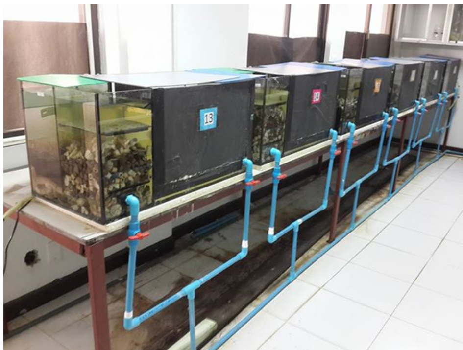
Vista de la configuración experimental, con cada tanque teniendo su propio sistema de recirculación de agua.
