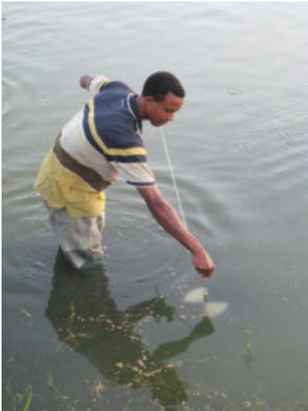
El disco de Secchi es una herramienta simple y efectiva que se usa para medir la transparencia del agua o la turbidez en cuerpos de agua. Foto de Darryl Jory.
