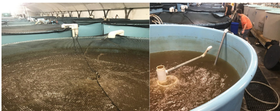
Fig. 1: Diseño de tanque experimental de 1 metro cúbico. El tanque a la derecha, parcialmente drenado, muestra el sistema de circulación impulsado por el puente de aire.
