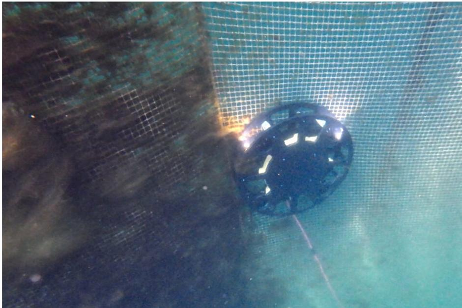
El robot Probotic en acción limpiando corrales de redes. "Funcionan como una aspiradora robótica, empujándose hacia la red y deslizándose en un movimiento circular antes de descender más profundamente," dijo Mikkel Pedersen de Probotic. "Y están allí todo el día, manteniendo las redes limpias, haciendo mantenimiento preventivo." Foto cortesía de Probotic.
