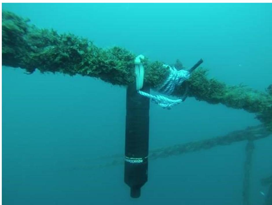
La imagen arriba fue tomada en un desafiante ambiente mar afuera, donde olas de 2,5 metros (8 pies) en la superficie son típicas. El sensor se despliega en una línea de amarre con un amarre de cierre plástico y una cuerda. No hay cables y este sensor fue instalado en menos de 5 minutos.
