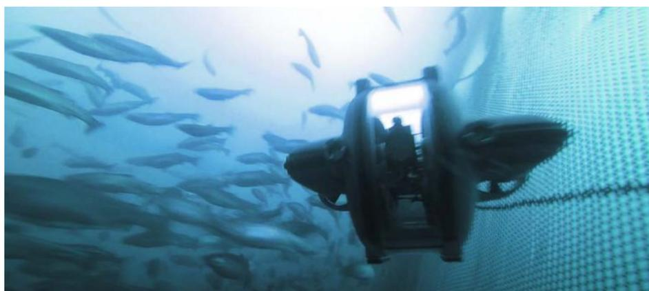
Deep Trekker fabrica herramientas de inspección submarinas portátiles como el DTX2 ROV – un vehículo submarino operado remotamente (ROVs) que es alimentado por baterías y ampliamente utilizado por las empresas acuícolas a nivel internacional.
